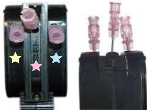
Ángulo con el que se deben insertar las agujas.
